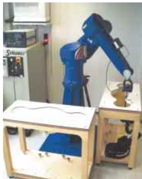
Die Messungen von Strahlungen werden mit Hilfe eines Roboters durchgeführt.
